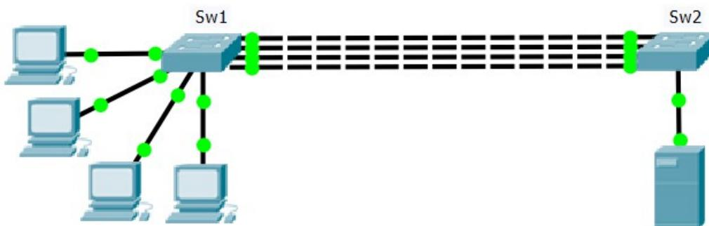
Bei SRC MAC Lastverteilung auf Sw2 würde Datenverkehr vom Server zu den Clients lediglich über immer die gleiche einzelne physikalische Verbindung gesendet.
